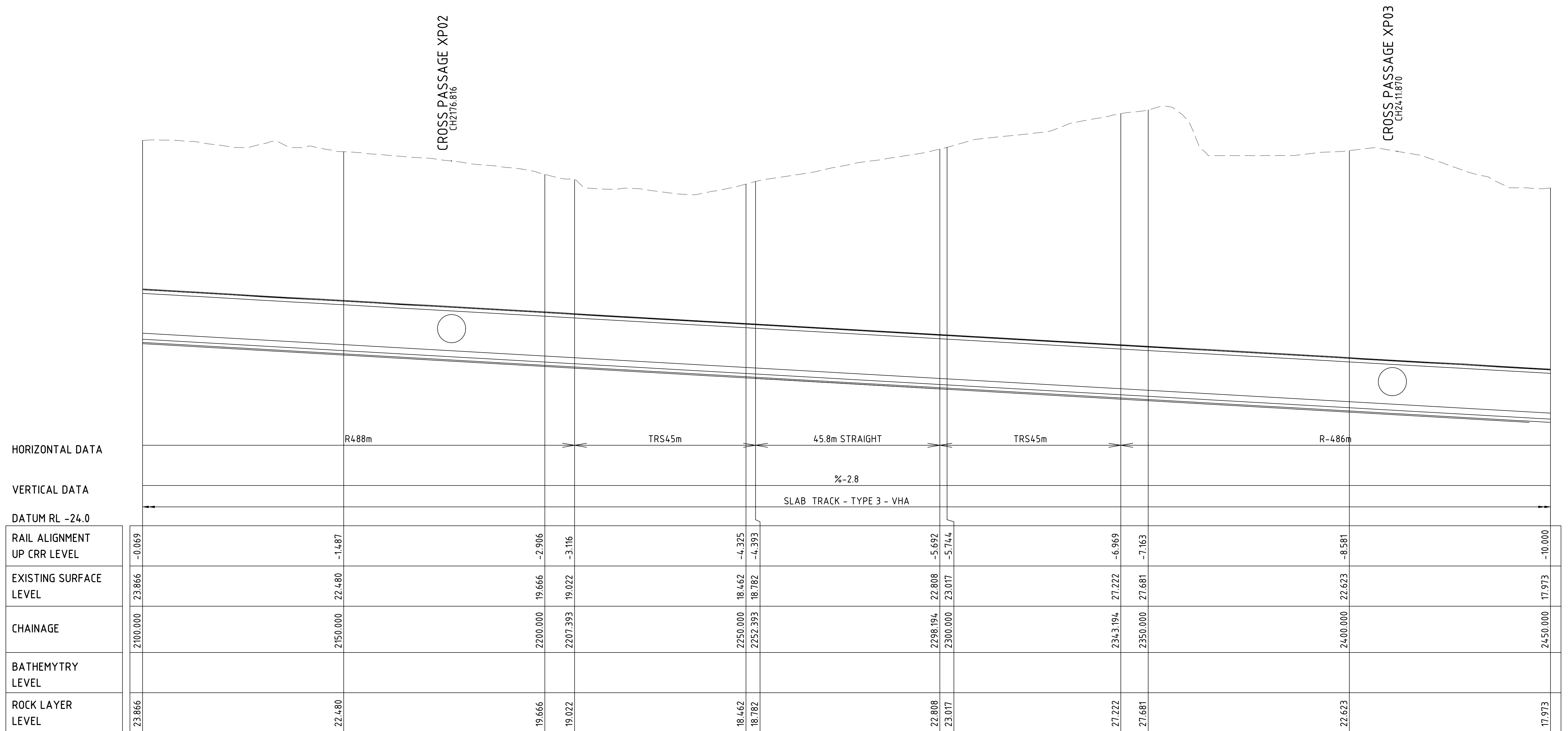
LONGITUDINAL SECTION MC02 (UP TRACK)
